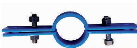
**JEKLENA OBJEMKA** za držanje stolpa cevi med spuščanjem; namestiti jo je treba na razdalji najmanj 300 mm od razširjenega dela cevi, da se preprečijo deformacije navoja.
