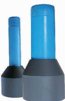
**PVC REDUKTORJI** z ženskim navojem, opremljeni s PVC obojko z dvema moškima navojema, uporabljajo se za povezovanje PVC cevi z različnimi premeri, kadar je črpalna komora širša od jaška za ekstrakcijo.
