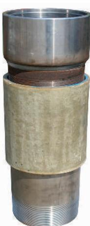
**DIELEKTRIČNI SPOJNIK**. Bistvenega pomena za zagotovitev trajne električne izolacije med enim in drugim materialom, kadar je stolp cevi sestavljen iz cevi različnih materialov (npr. iz nerjavavečega jekla in ogljikovega jekla); dielektrični spojnik poleg tega ščiti nadaljnji del strukture pred morebitnimi blodečimi tokovi.
