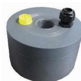
**PVC GLAVE ZA ZAPIRANJE VODNJAKA** na potisk, z luknjo na sredini, pokrovčkom in kabelsko uvodnico. V primerjavi z običajnimi glavami za zapiranje so cenejše in se hitreje nameščajo, ker nimajo vijakov in matic; izolacija vodnjaka od zunanjega okolice je zagotovljena z gumijastim tesnilom (o-ring) na notranji strani.
