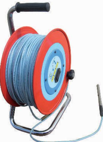
**PRENOSNA SONDA NIVOJA** za merjenje višine vode v vodnjakih, piezometrih itd. Pripomoček sestavlja: okrogel kabel z označenimi centimetri, ki je na voljo v različnih dolžinah od 50 do 500 metrov, konica iz jekla inox 304 Ø 12 mm, kabelski kolut, ročaj za prenašanje in elektronski modul z zvočnim in svetlobnim signalizatorjem in led sijalko, ki opozori na prazno baterijo.
