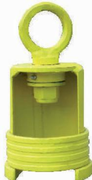
**ZVONASTI ELEMENT ZA DVIGANJE IZ JEKLA**, primeren samo za cevi z razširivijo (z navoji ali brez). Ob dvigu ušesa se element za dviganje zapre pod razširjenim delom cevi.
